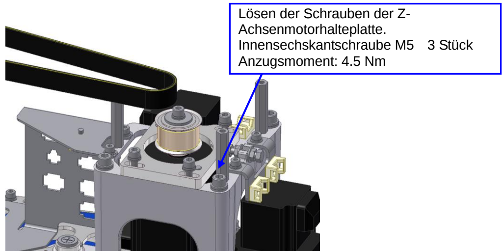
Bild 5-13 Entfernen des Z-Achsenzahnriemens
